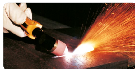
Plasmafugen zur Vorbereitung von Schweißnähten Plasma gouging for weld preparation purposes
