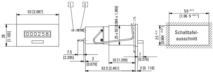
1) Rundsteckhülse  $\varnothing$  1,5 mm verzinkt    2) Rundstift  $\varnothing$  1,6 mm verzinkt
