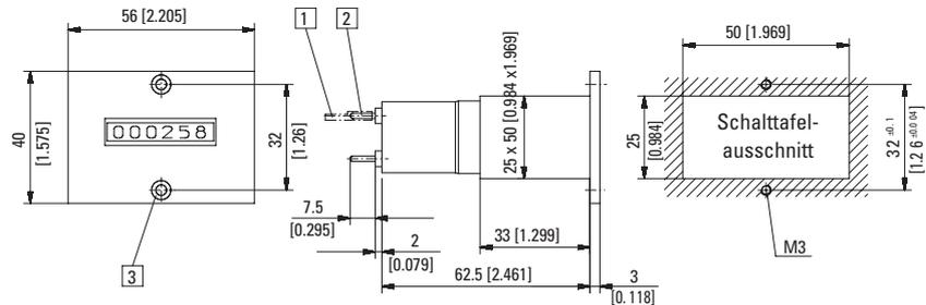
1 Rundsteckhülse  $\varnothing$  1,5 mm verzinkt 2 Rundstift  $\varnothing$  1,6 mm verzinkt 3 Senkung Af3 DIN 74
