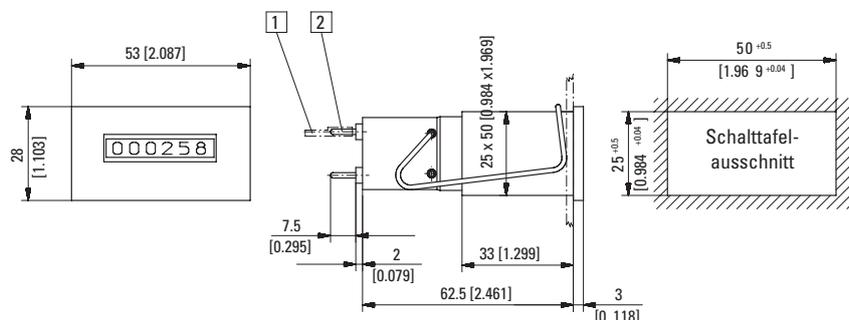
1 Rundsteckhülse  $\varnothing$  1,5 mm verzinkt 2 Rundstift  $\varnothing$  1,6 mm verzinkt
