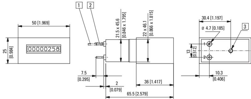
1) Rundsteckhülse  $\varnothing$  1,5 mm verzinkt 2) Rundstift  $\varnothing$  1,6 mm verzinkt 3) M4, 5 mm tief
