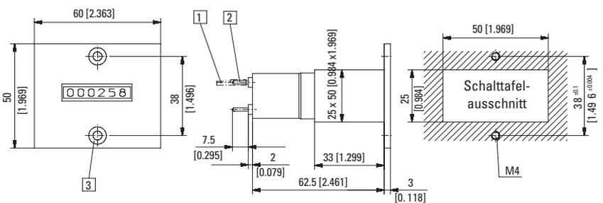
1) Rundsteckhülse  $\varnothing$  1,5 mm verzinkt    2) Rundstift  $\varnothing$  1,6 mm verzinkt    3) Senkung Am 4 DIN 74
