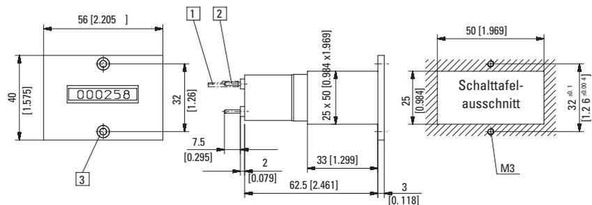
1 Rundsteckhülse  $\varnothing$  1,5 mm verzinkt 2 Rundstift  $\varnothing$  1,6 mm verzinkt 3 Senkung Af3 DIN 74
