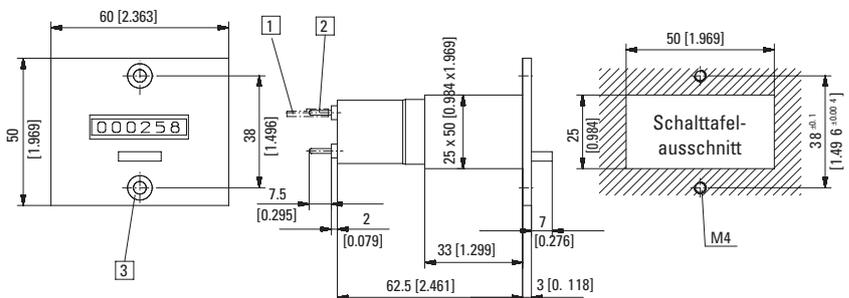
1) Rundsteckhülse  $\varnothing$  1,5 mm verzinkt    2) Rundstift  $\varnothing$  1,6 mm verzinkt    3) Senkung Bf 4 DIN 74
