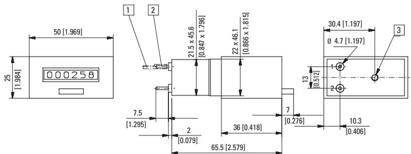
1) Rundsteckhülse  $\varnothing$  1,5 mm verzinkt    2) Rundstift  $\varnothing$  1,6 mm verzinkt    3) M4, 5 mm tief
