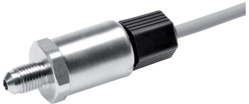
Die kompakten Drucktransmitter der Typenreihe 520 basieren auf der von Huba Control entwickelten Dickschicht-Technologie, bei der die Druckmesszelle dichtungsfrei mit dem Druckaufnehmer verschweisst ist.
