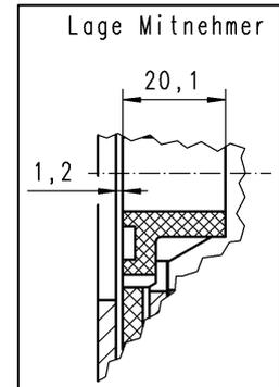
Zum Anbau der Bremse muss die Befestigungsfläche (11) folgende Anforderungen erfüllen:
