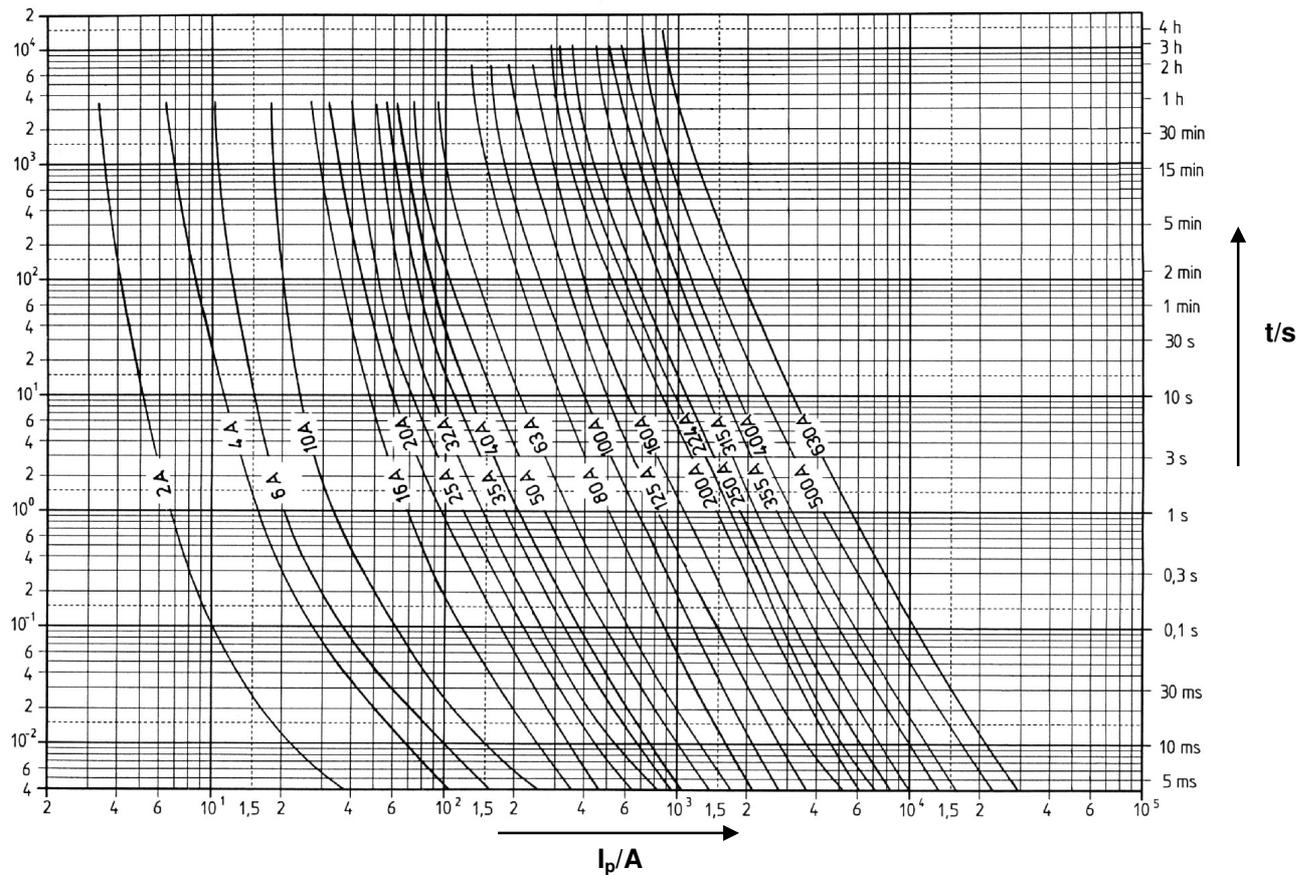
Die mittleren Zeit-Strom-Kennlinien gelten bei einer Umgebungstemperatur von  $20 \pm 5^\circ\text{C}$  und den Kabel-(Leitungs-)querschnitten der relevanten Vorschriften.
